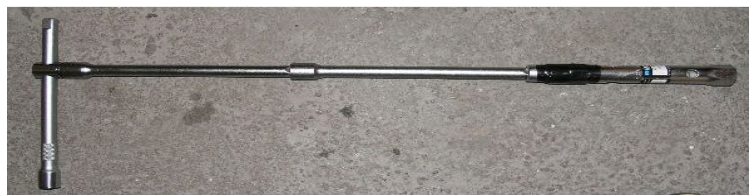
Jetzt nur noch die zwei Verlängerungen in die Knarrenuss stecken und oben entweder eine Knarre oder ein T-Stück einer Knarre einstecken.
