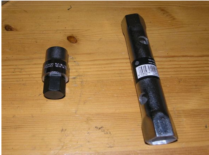
19mm Innensechskant für 1/2 Zoll Knarre und Steckschlüssel 20x22mm
