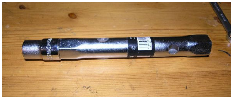
Innensechskant in den Steckschlüssel (20mm Seite) stecken und mit Panzertape festkleben damit der Schlüssel nicht von der Nuss abrutscht.
