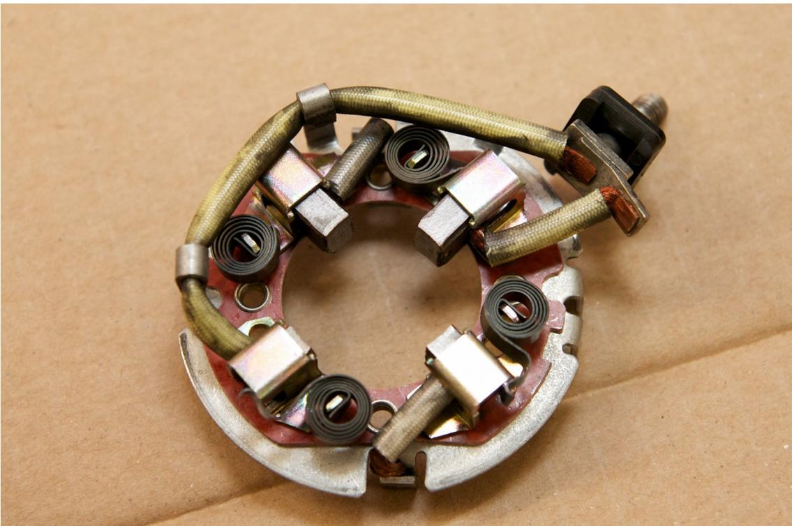
Die Federn der Kohlen wird sauber in Position bringen, so dass die Kohlen an die Kontakte gedrückt werden.
