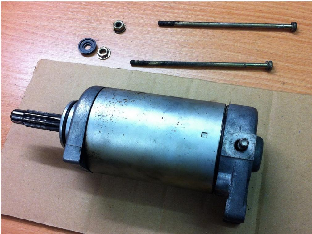
Die seitlichen Deckel können vorsichtig abgezogen werden. Der Bolzen für die Kabelbefestigung muss dabei vorsichtig aus der Öffnung gezogen werden.
