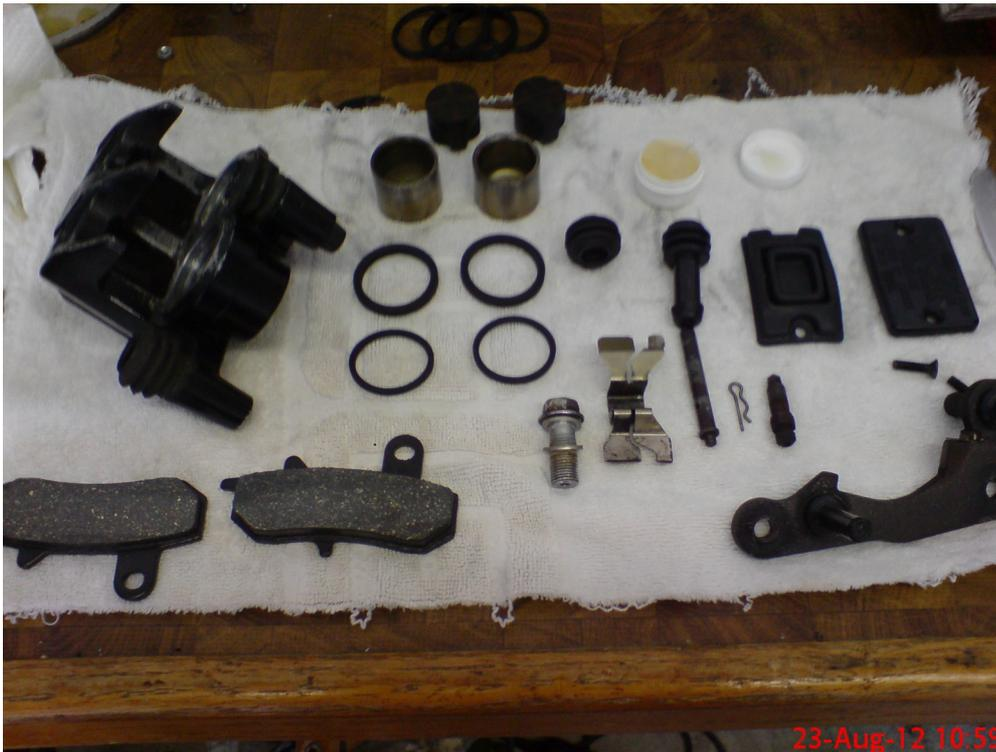
Die Dichtungen mit der mitgelieferten Bremsenpaste leicht einschmieren...
