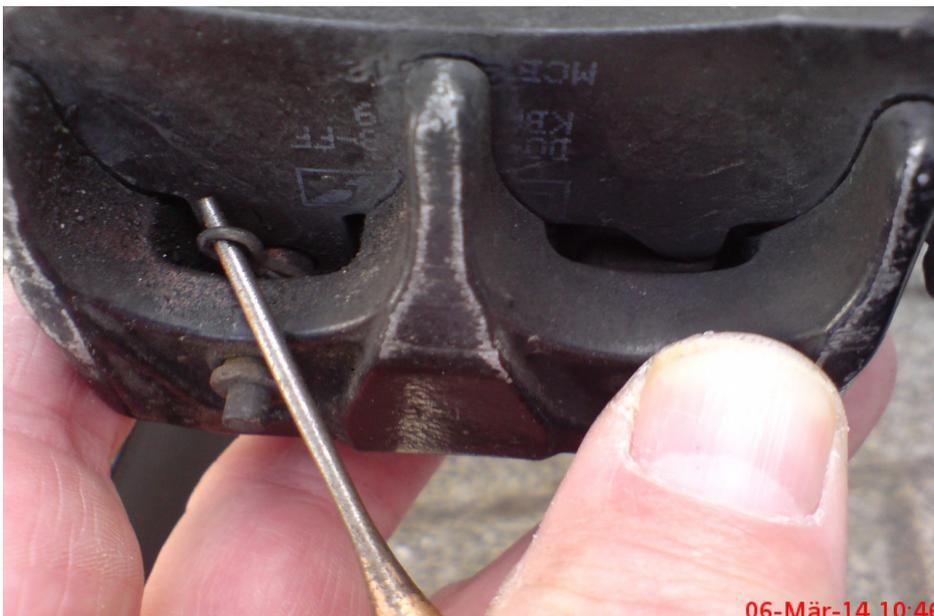
Dann **5.) den Führungsbolzen** selbst.. ganz sachte mit einer Zange unter drehenden Bewegungen herausziehen... und möglichst nicht mit der Zange abrutschen...
