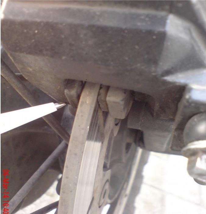
Der „innere“ Bremsbelag hat grundsätzlich eine geringere Belagsstärke und ist schneller „runter“! Der hier ist schon fast fertig, die Trägerplatte des Bremsbelags hat schon fast die Bremsscheibe erreicht! = Zeit zum wechseln!
