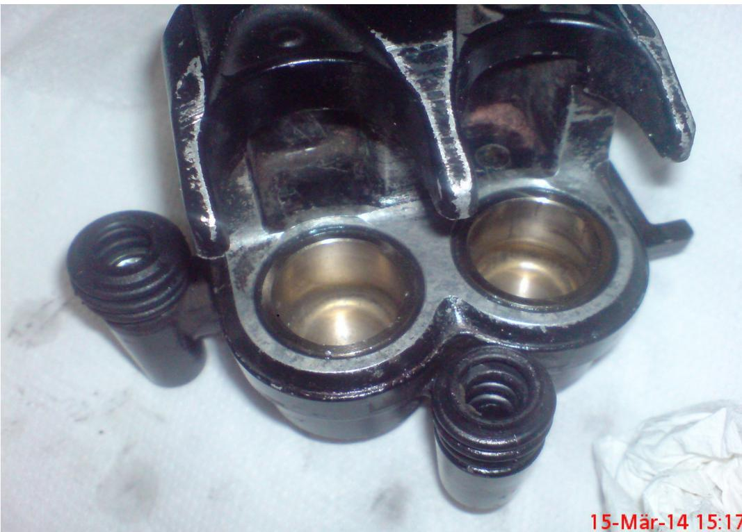
...die Staubdichtungen/ Faltenbälge des Bremssattelträgers sind auch schon ausgetauscht!
