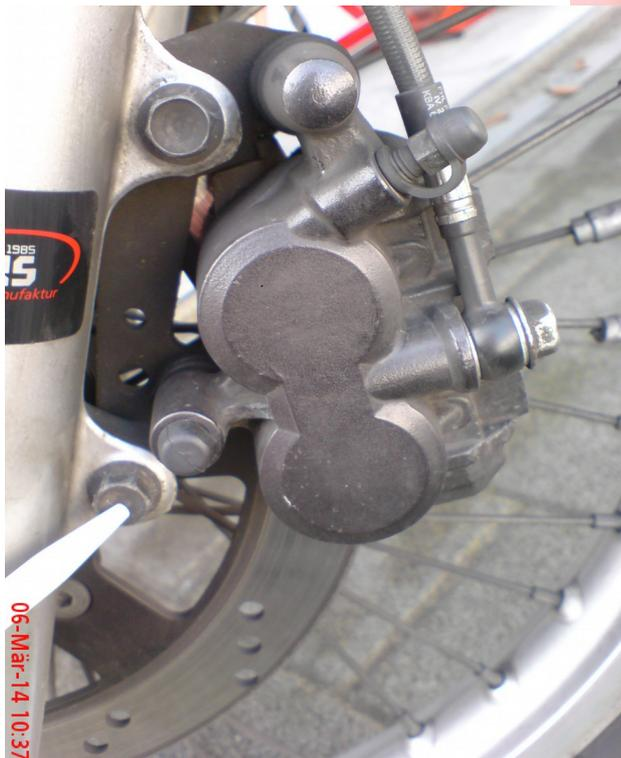
...und die vorderen Bremssattelbefestigungsschrauben, unten und oben am Gabelholm...
