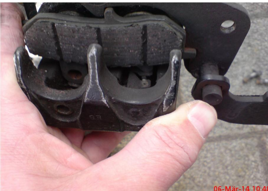
Da haben wir den Salat: Die Staubdichtung ist herausgequollen, der Bremssattel muss also überholt werden!
