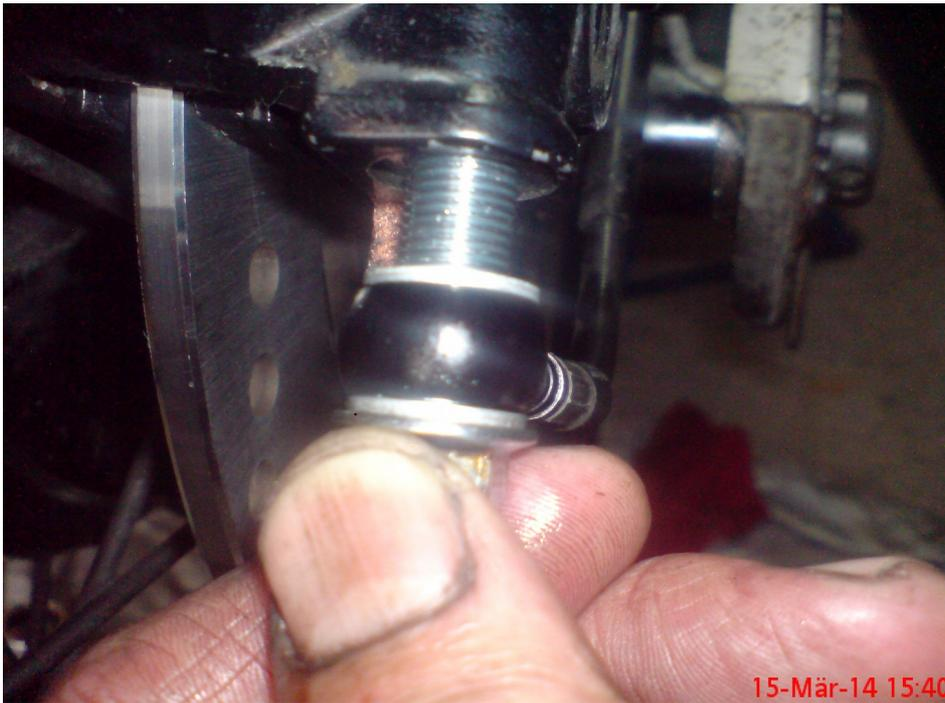
...und mit dem Drehmomentschlüssel ( 16-20 Nm)festziehen!
