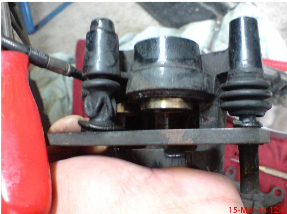
..der Gummi links ist etwas kniffliger: der muss durch den Halter am Sattel gezogen werden...
