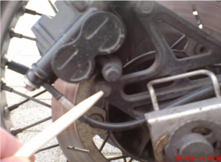
Die Befestigungsschrauben des hinteren Bremssattels
