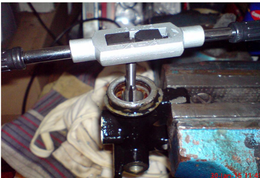
...Schraube M8x 50 mit Mutter und Karo-Scheibe eingeschraubt, dann mit der Mutter gegen die Karo-Scheibe den Koben rausgezogen....
