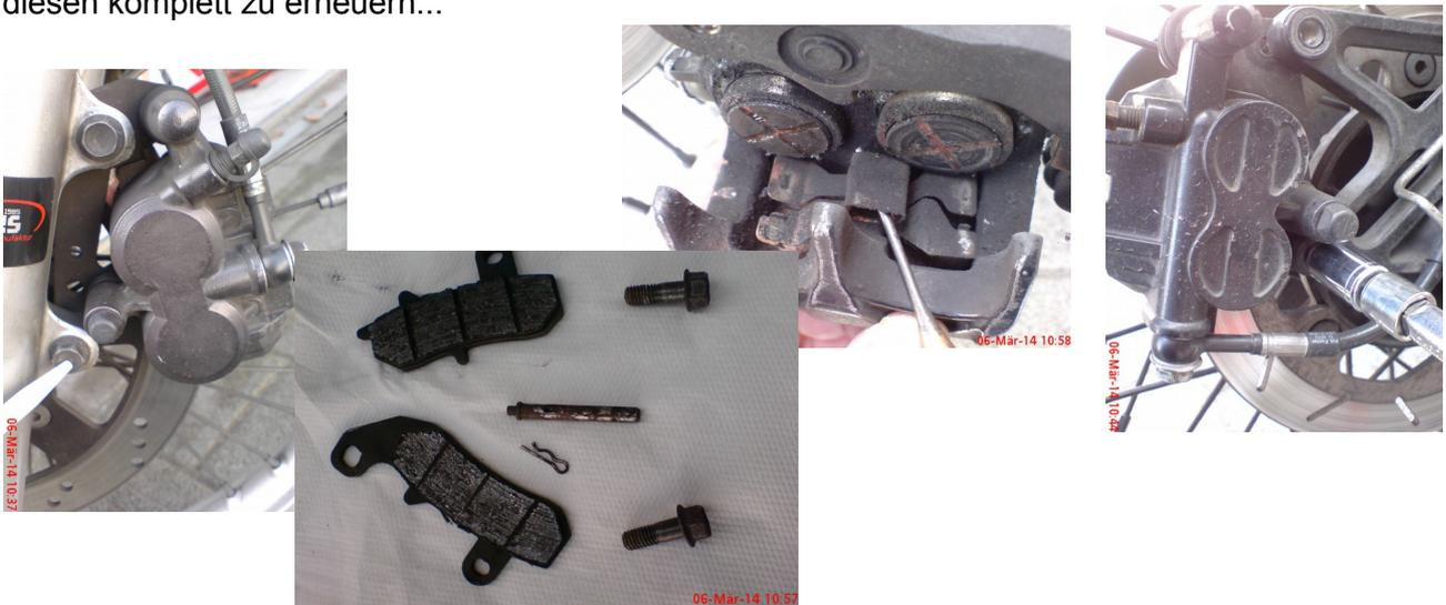
**8.) Bremssattelträgerplatte abziehen:** im Idealfall geht das mit etwas Widerstand, weil sich in den kleinen Faltenbalgen- Gummis beim ziehen ein Unterdruck aufbaut, = gutes Zeichen, dann sind die Dinger nämlich noch dicht...
