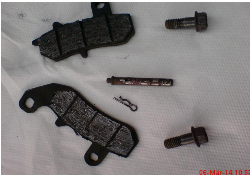
An den „Querrillen“ (= Verschleiß- Nut) im Bremsbelag kann man erkennen, dass dieser sogar einseitig abgenutzt ist! Das kann u.U. von einer schräg eingelaufenen Bremsscheibe herrühren, Scheibe genau anschauen! Wenn die Scheibe bald die Verschleißgrenze erreicht hat, sollte die auch ausgetauscht werden, kommt später im Kap. Bremsscheibe auch noch...
