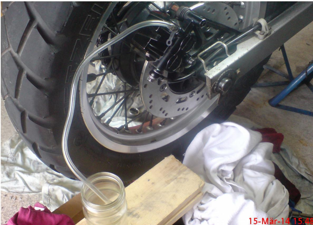
Beim Pumpen (Befüllen der Bremsanlage) immer wieder den Flüssigkeitsstand im Behälter im Auge behalten, sonst pumpt man wieder Luft ins System...
