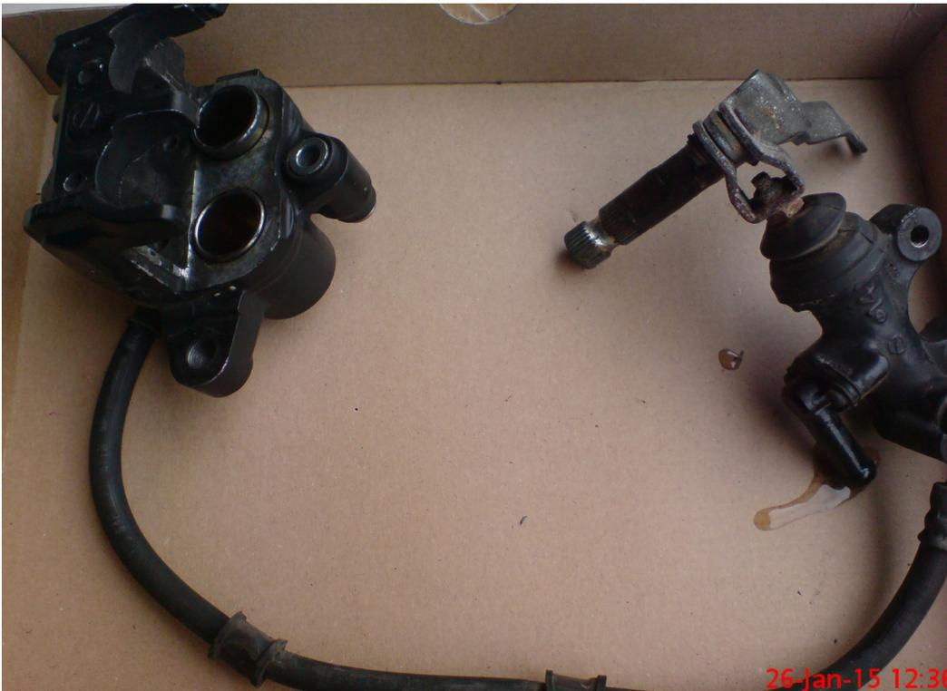
Mit den neuen Reparatursätzen und einer Stahlflex- Leitung, bereit zum zerlegen...
