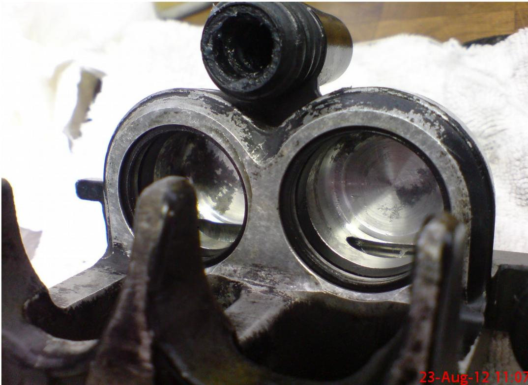
Ebenfalls mit den Fingern einen ganz leichten Film der Bremsenpaste außen auf die Bremskolben auftragen und dann vorsichtig in den Sattel eindrücken. Dabei darauf achten, dass die Dichtungen in ihrer Nut bleiben!
