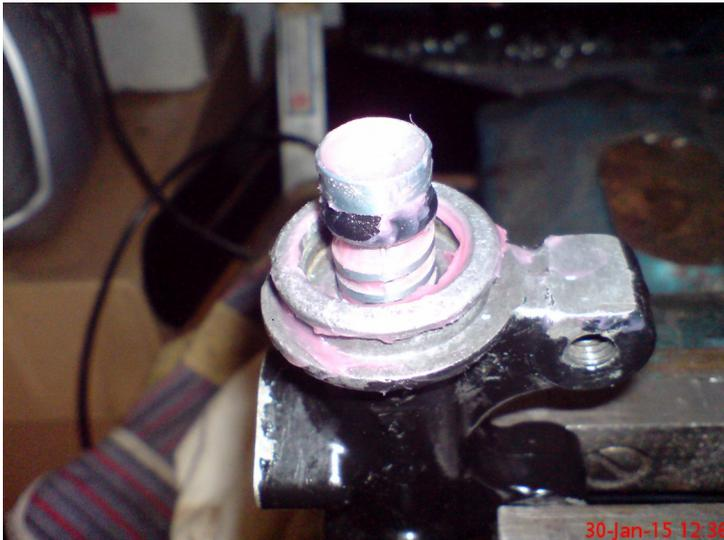
...Seegerring rein, Gummikappe drüber, fertig ist die überholte Bremspumpe!!!
