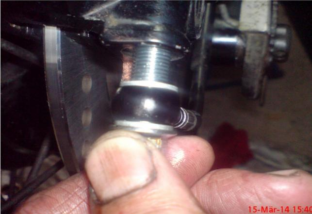
Sodann: **11.) Dichtungen** aus dem Bremssattel entfernen geht am besten mit einer Anreißnadel oder etwas ähnlich spitzem! **Aber Vorsicht! Keine Kratzer hinterlassen!** Zuerst die oberen Staubdichtungen...
