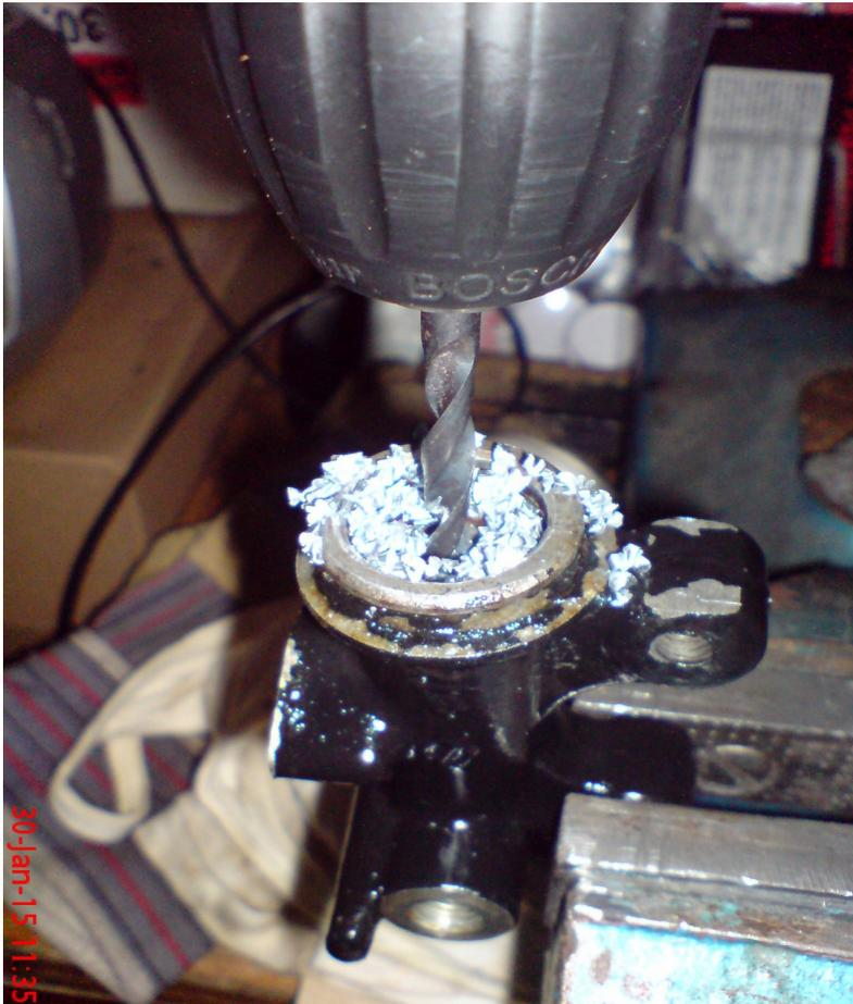
...um ein M8 er Gewinde in den Kolben zu schneiden...
