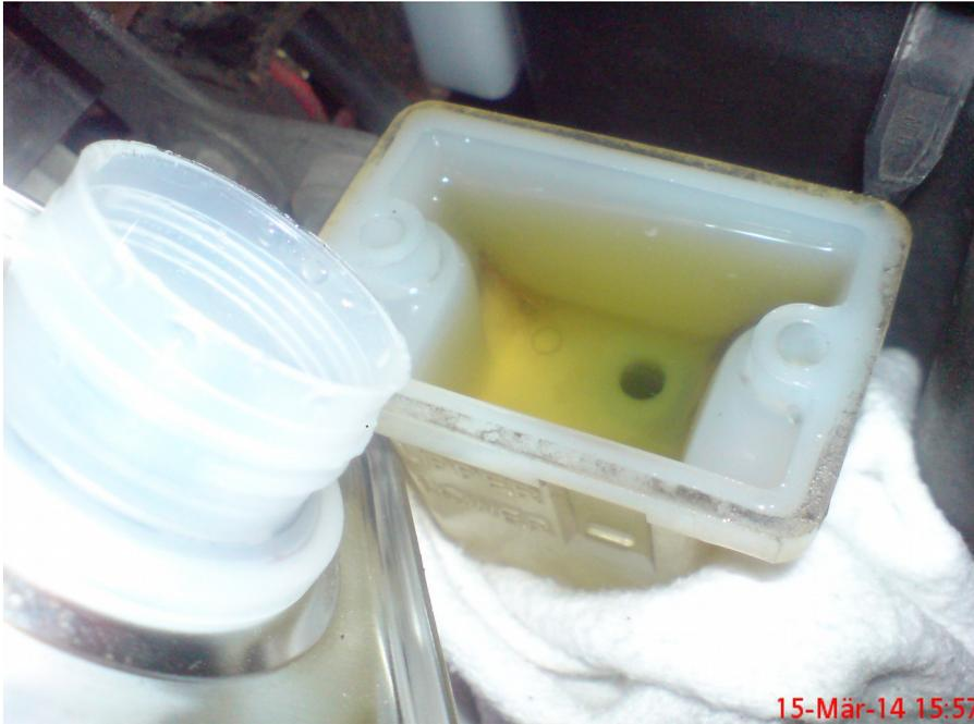
Staubschutzkäppchen von der Entlüftungsschraube abnehmen, Entlüftungsschraube (SW 8) ca. 1-2 Umdrehungen ausdrehen, Entlüftungsschlauch aufstecken, anderes Ende in ein altes Glas und mit der Bremspumpe gemächlich pumpen...
