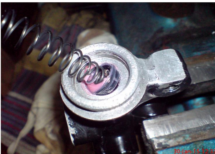
...erst die Feder mit der unteren Dichtung mit **etwas** Bremsenpaste\_(im Set enthalten) einsetzen, (zugegeben, bisschen viel aufgetragen, hab ich nochmal abgewischt!)
